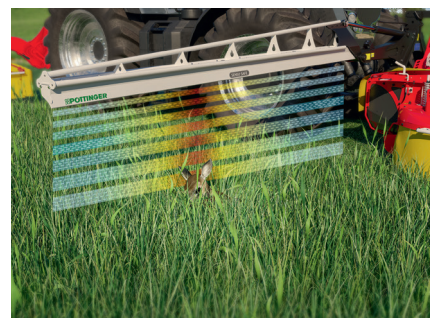
Mit Sensortechnik Rehkitze retten: Pöttingers Maschinen werden immer komplexer, umso konsistenter und verlässlicher müssen die Engineeringdaten sein. Bilder: Pöttinger
