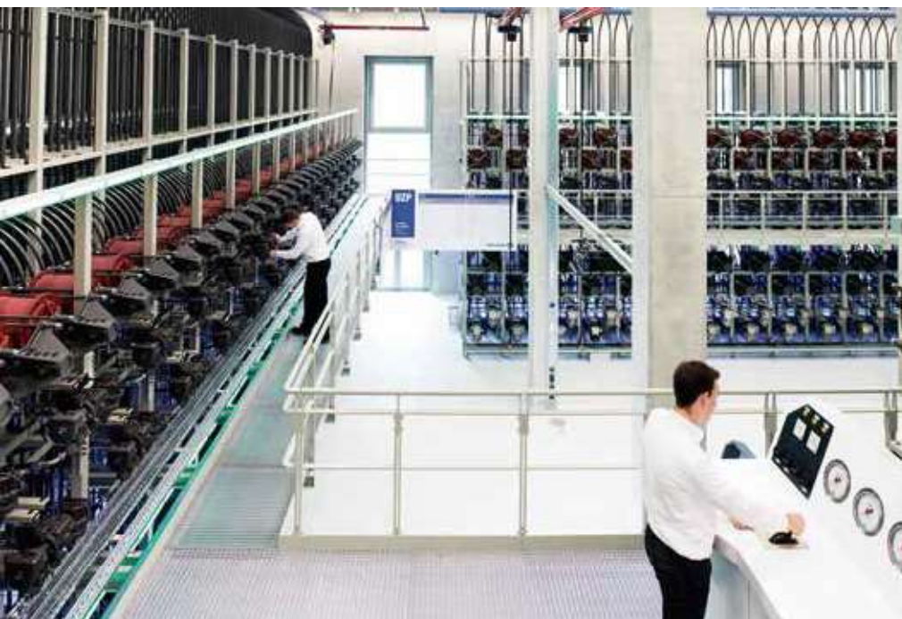
Einblick in die Entwicklung im Münchener Knorr-Bremse-Werk: Prüfstände testen die Performance von Zugbremssystemen.
