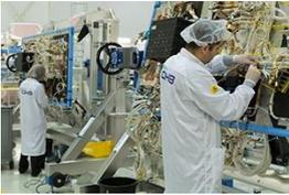
[Harness-Arbeiten am Galileo-FOC-Satelliten](#). Die digitale Kabelstrangentwicklung erfolgt in Engineering Base von Aucotec (© OHB System AG)
