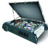
Dachcontainer einer Traktions- und Bordnetzausrüstung
