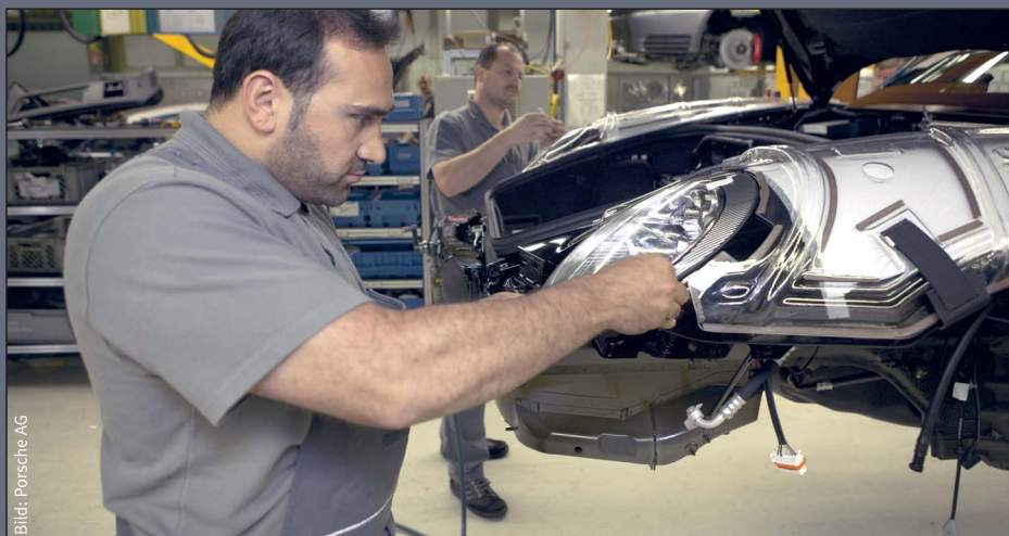
Einbau der Hauptscheinwerfer: Teil der Porsche-Philosophie ist, dass bestimmte Bauteile wie etwa der Scheinwerfer links immer dieselbe UL-ID erhalten (Usage Location Identification). Auf diese Weise lassen sich Fehler sowohl in der Entwicklung als auch in Montage und Service vermeiden.
