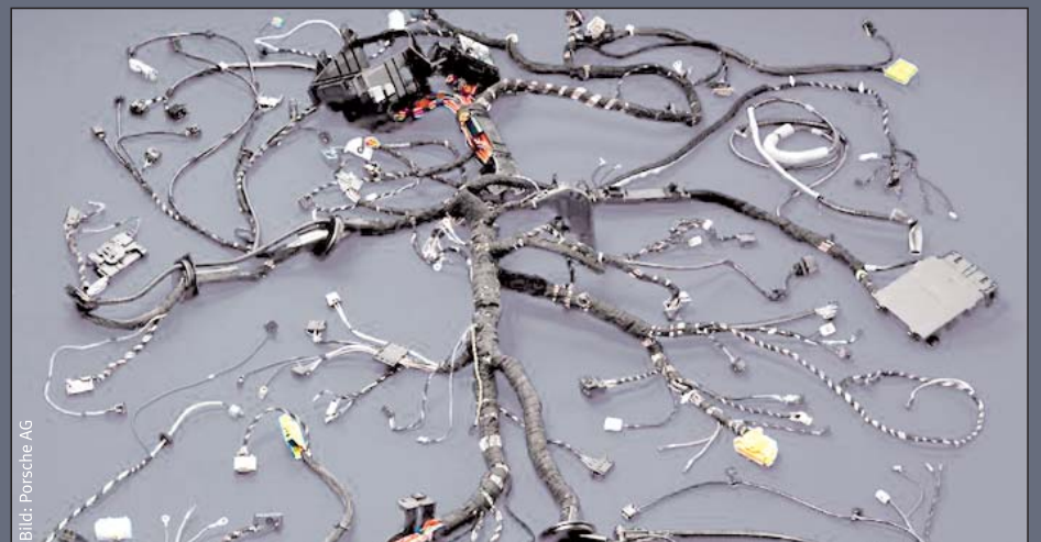
Das „Nervensystem“ eines Fahrzeugs: das Bordnetz
